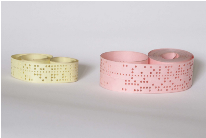
Rysunek: Po lewej stronie „standardowa” taśma dalekopisu, po prawej taśma ośmio-ścieżkowa, używana przez komputery
